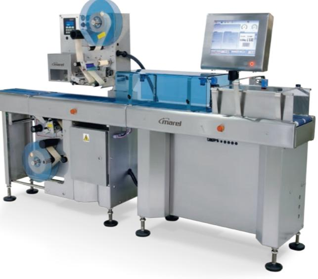
Pesage et étiquetage précis jusqu'à 100 paquets par minute.
