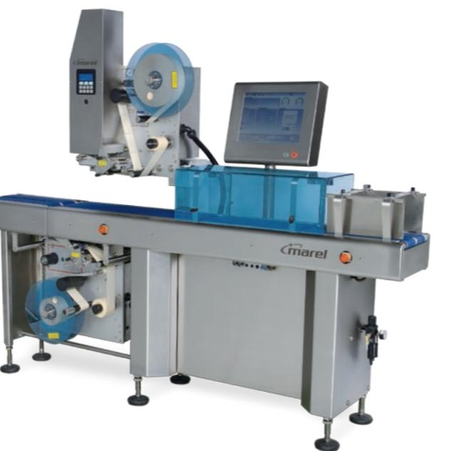
Pesage et étiquetage précis jusqu'à 60 paquets par minute.
